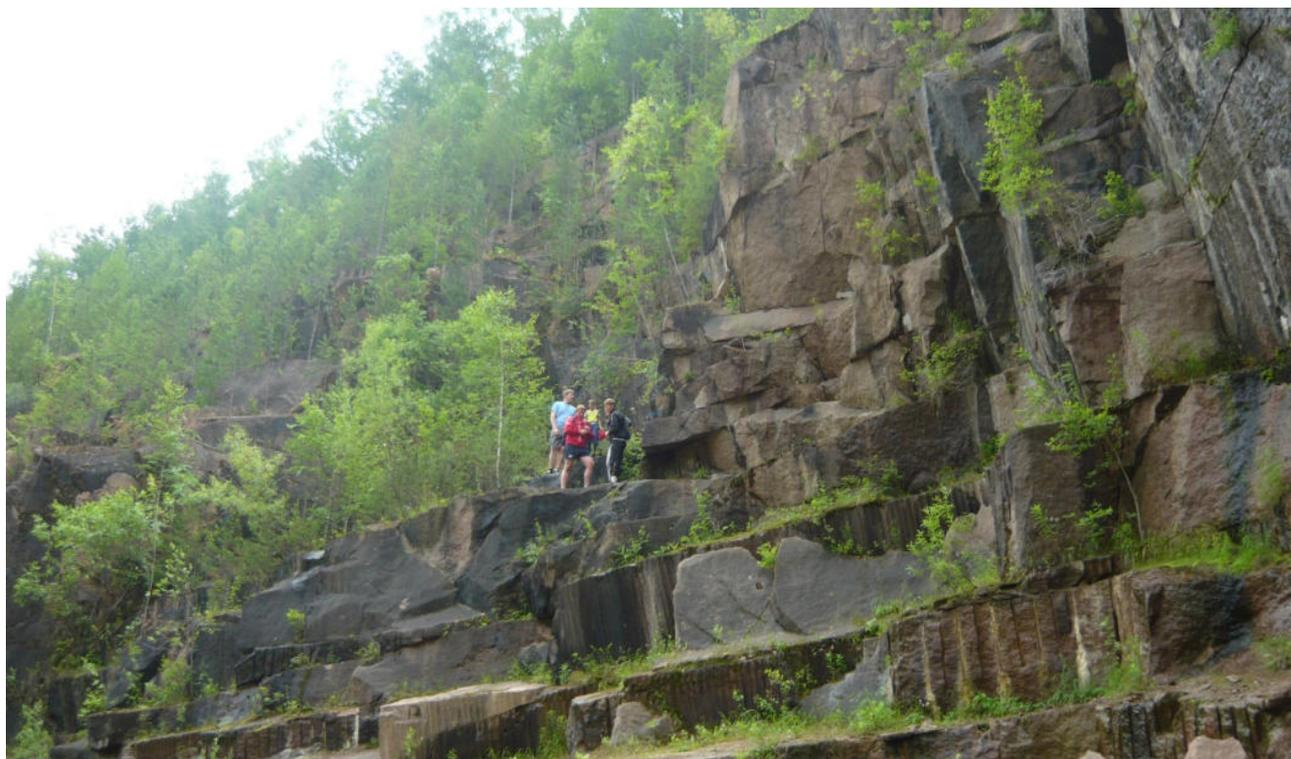
Рисунок 5 – Стенка сиенитового карьера с выраженными матрацевидными отдельностями
