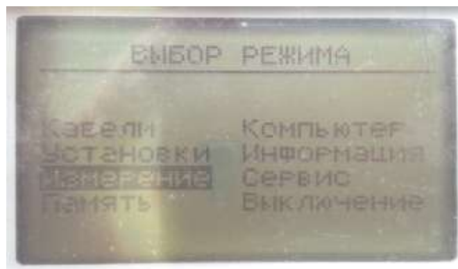
Рисунок 6 – Выбор пункта «Измерение» в меню кабельного моста ПКМ-105
