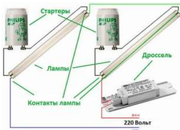
Рисунок 2 – Схема последовательного подключения двух люминесцентных ламп мощностью 18 Вт
