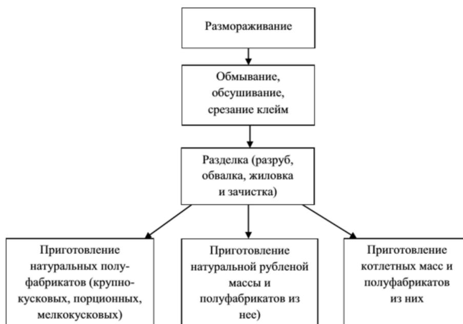
Рисунок 1 – Технологическая схема производства полуфабрикатов
