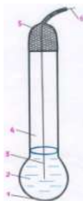
Рис. 18. Устройство стеклянного электрода:
