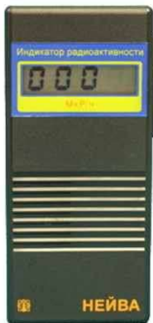
Рисунок 23 – Устройство прибора «НЕЙВА ИР-002»
