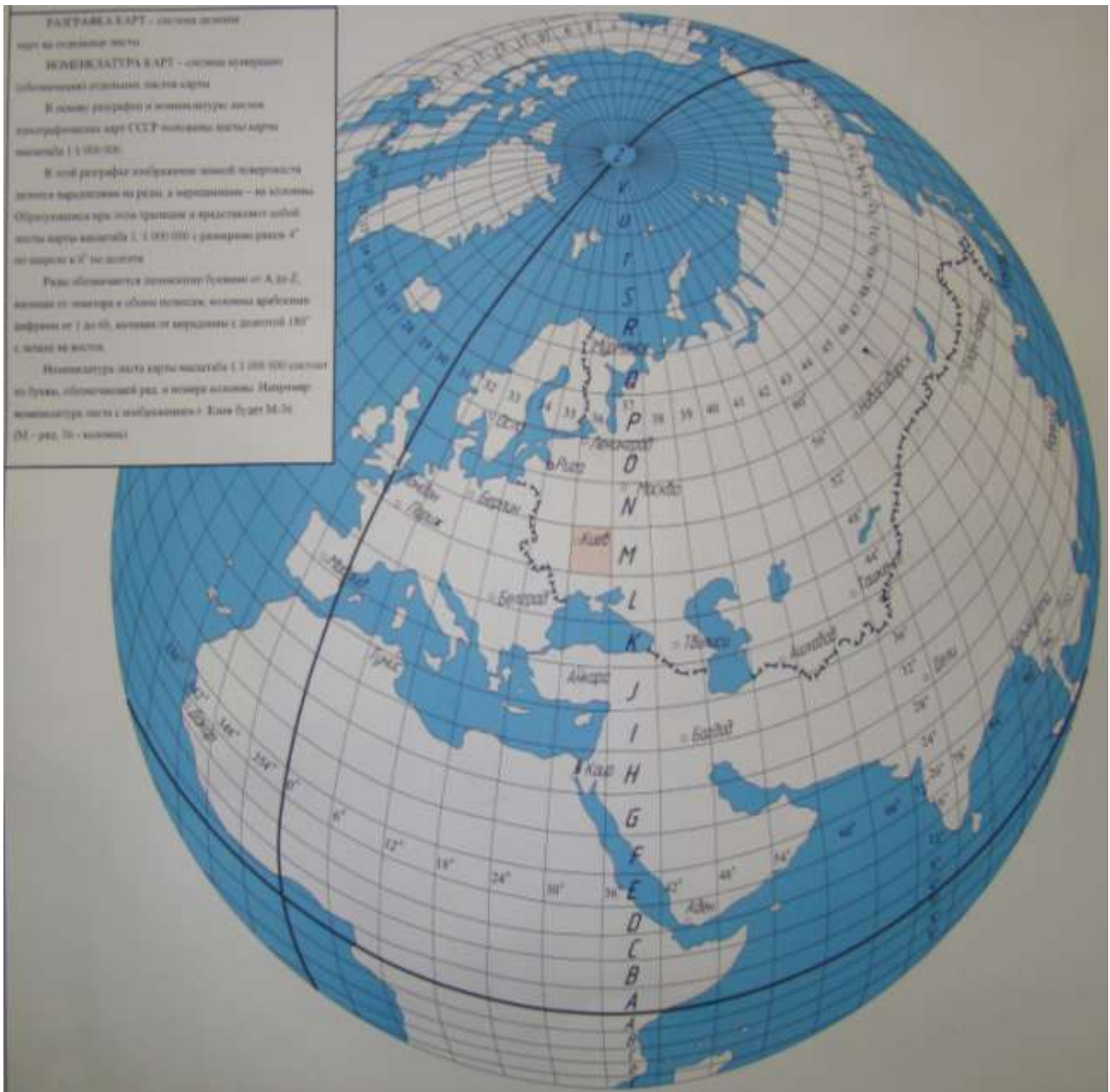
Рисунок 3 – Схема разграфки и номенклатуры листов карт масштаба 1:1 000 000 для северного полушария (номенклатура листа с изображением г. Киев М-36)
