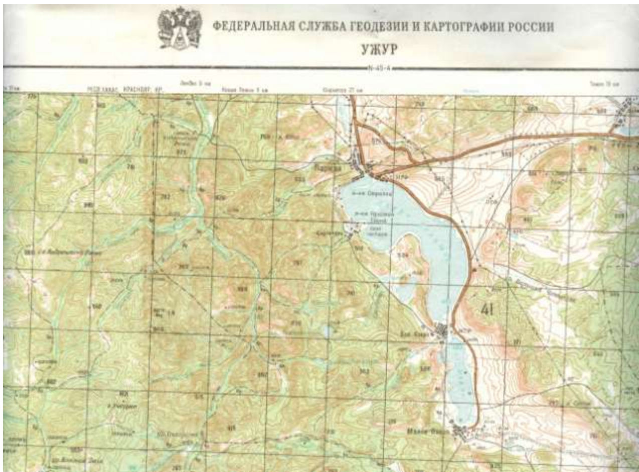
Рисунок 14 – Фрагмент топографической карты масштаба 1:200 000, номенклатура листа N-45-8. Размер трапеции по долготе 1.5°
