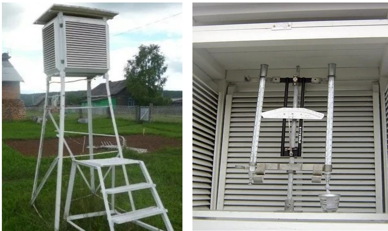
Рисунок 13 – Психрометрическая будка на метеостанции (слева) и станционный психрометр (справа)
