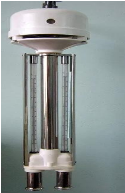
Рисунок 14 – Аспирационный психрометр (слева) и гигрограф волосной (справа)
