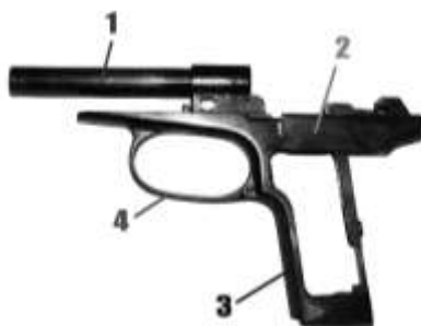
Рис. 9.19. Рамка со стволом и спусковой скобой:
