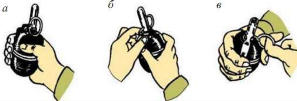
Рис. 9.65. Действия перед метанием ручной осколочной гранаты: а – прижатие спусковой скобы к корпусу гранаты; б – выпрямление концов предохранительной чеки; в – выдергивание предохранительной чеки
