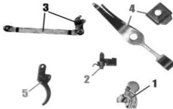
Рис. 9.25. Части ударно-спускового механизма: 1 – курок; 2 – шептало с пружиной; 3 – спусковая тяга с рычагом взвода; 4 – боевая пружина с задвижкой боевой пружины; 5 – спусковой крючок
