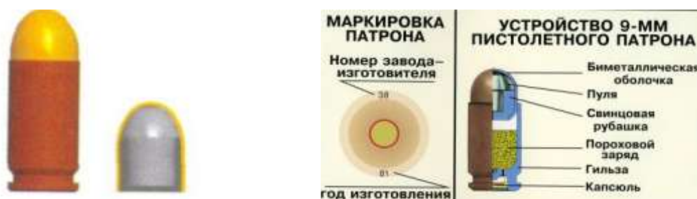
Рис. 9.34. Общий вид и устройство 9-мм патрона ПМ
