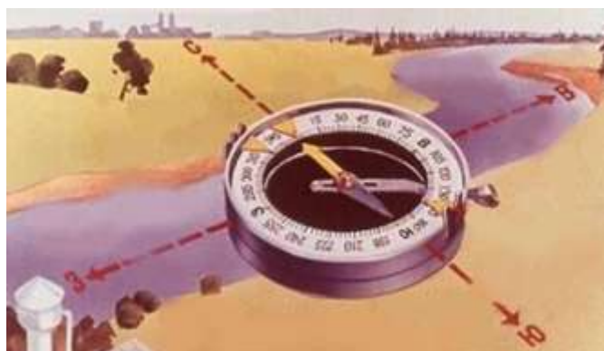
Рис. 10.10. Определение сторон горизонта по компасу
