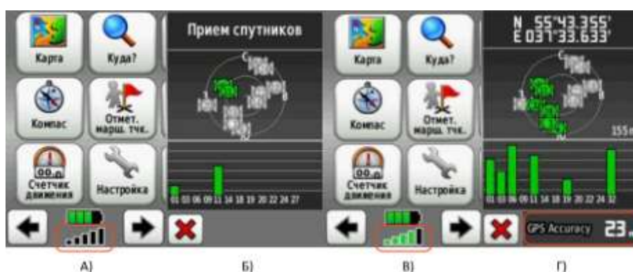
Рис. 10.19. Уровень сигнала и число спутников – не достаточно (а), расширенная информация (б), достаточно (в), точность позиционирования при текущем уровне сигнала (г)
