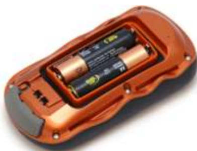
Рис. 10.18. Установка элементов питания в навигатор
