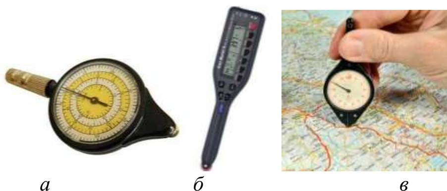
Рис. 10.8. Курвиметр: а – механический; б – электронный; в – измерение расстояния с помощью курвиметра
