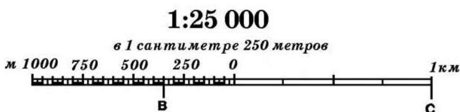
Рис. 10.5. Линейные масштабы топографических карт
