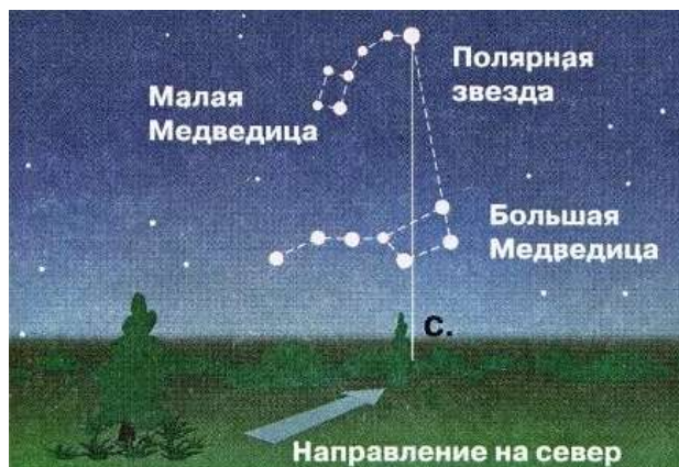
Рис. 10.12. Определение сторон горизонта по Полярной звезде
