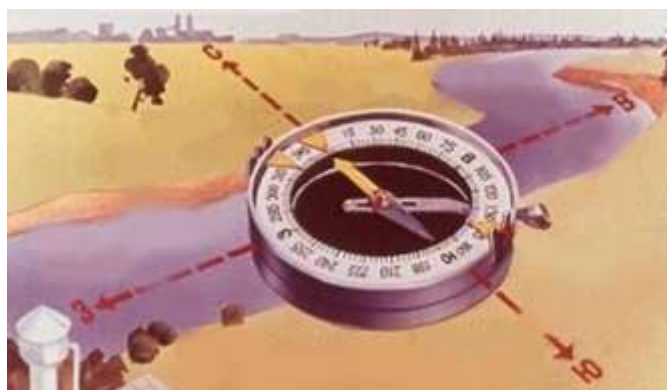
Рис. 10.10. Определение сторон горизонта по компасу
