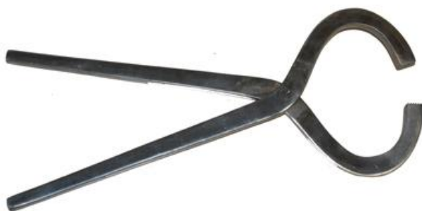
Рисунок 33 – Пробные щипцы для исследования копыт
