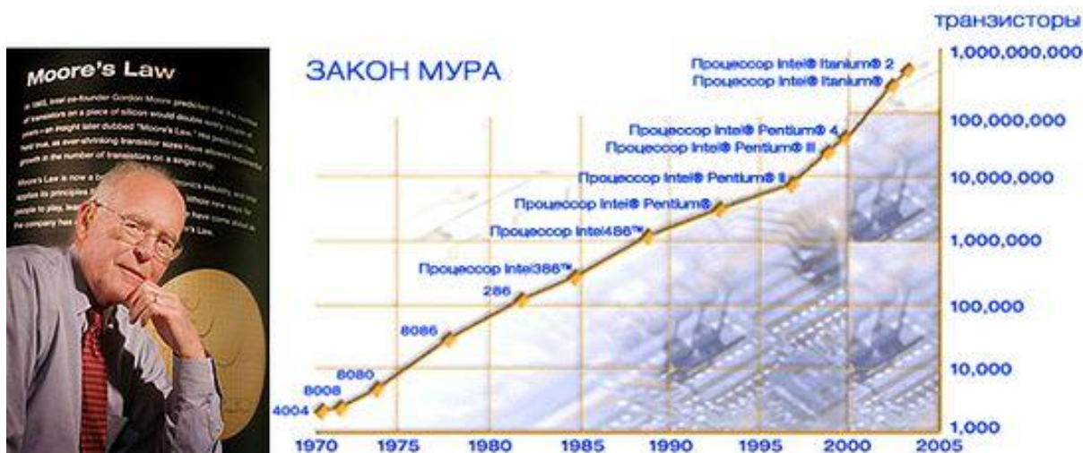
Рисунок 4.4 – Закон Мура, иллюстрирующий динамику изменения плотности транзисторов на кристалле процессора
