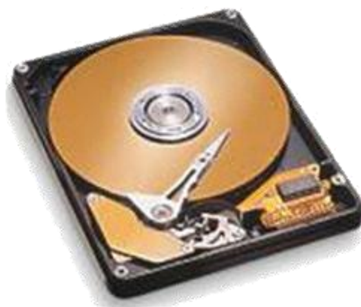
Рисунок 4.8 – Винчестерский накопитель со снятой крышкой корпуса
