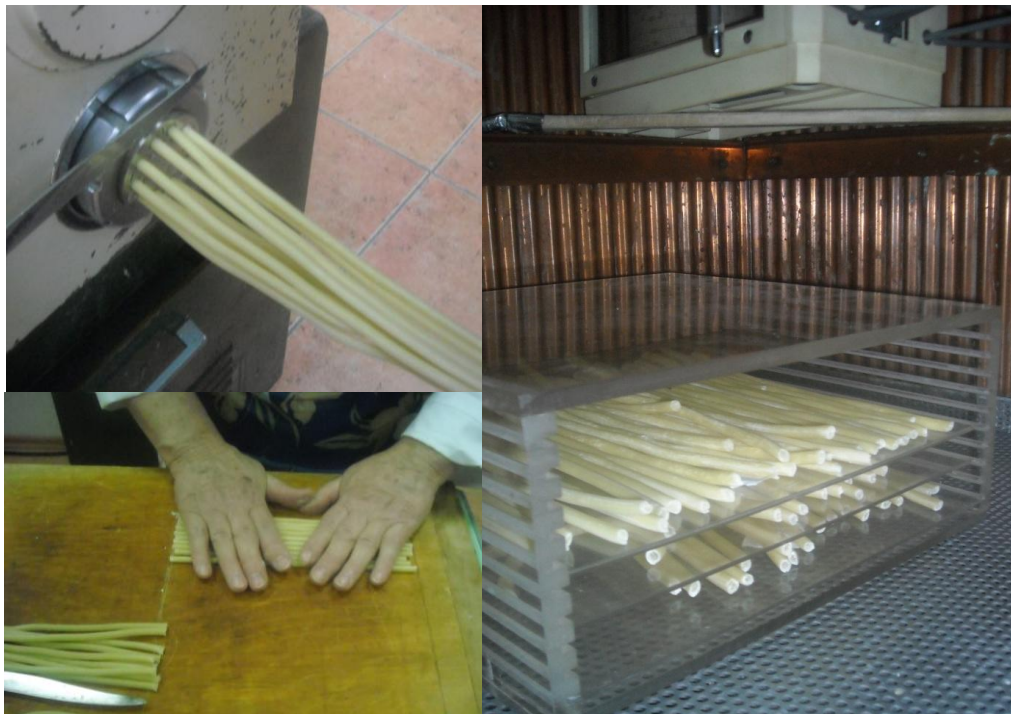
Рис. 1. Формование, нарезка полуфабриката и укладка в кассеты
