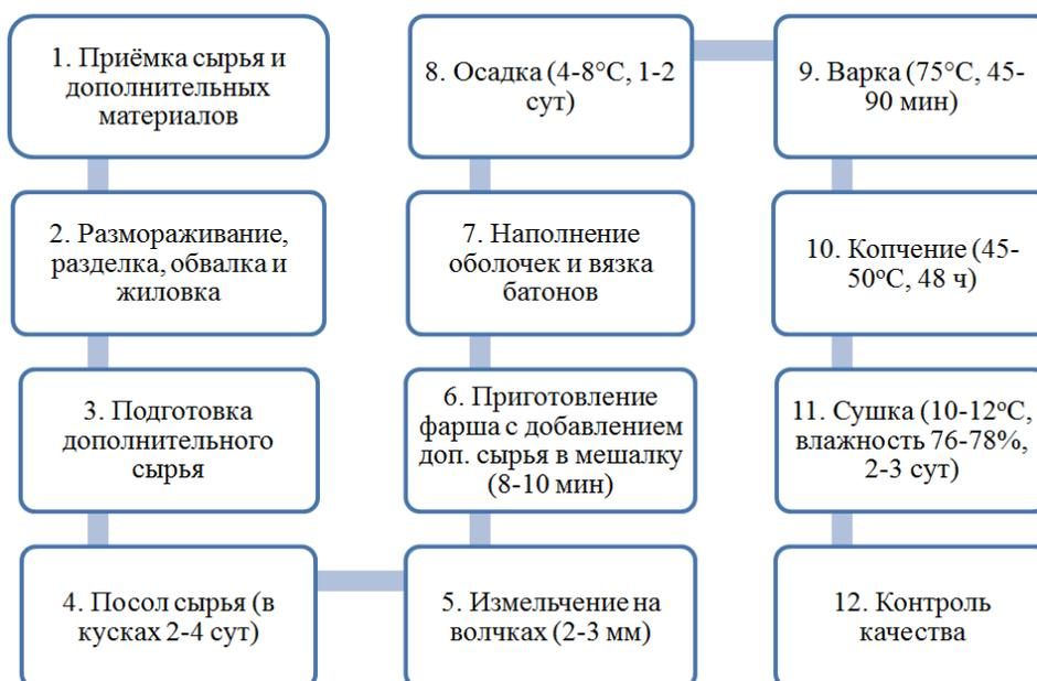
Рис. 1. Технологическая схема производства варено-копченой колбасы из мяса диких животных
