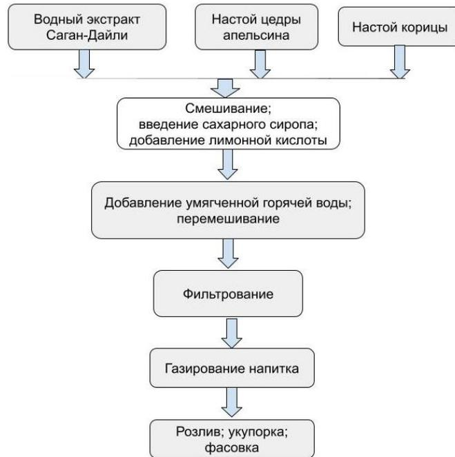
Рис. 3. Технологическая схема производства безалкогольного напитка на основе экстракта Саган-Дайля
