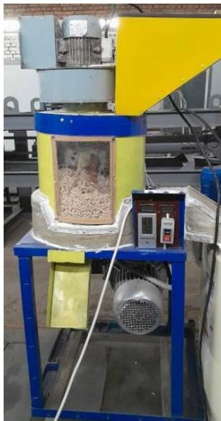
*Рис. 2. Общий вид оборудования для охлаждения экструдата*
