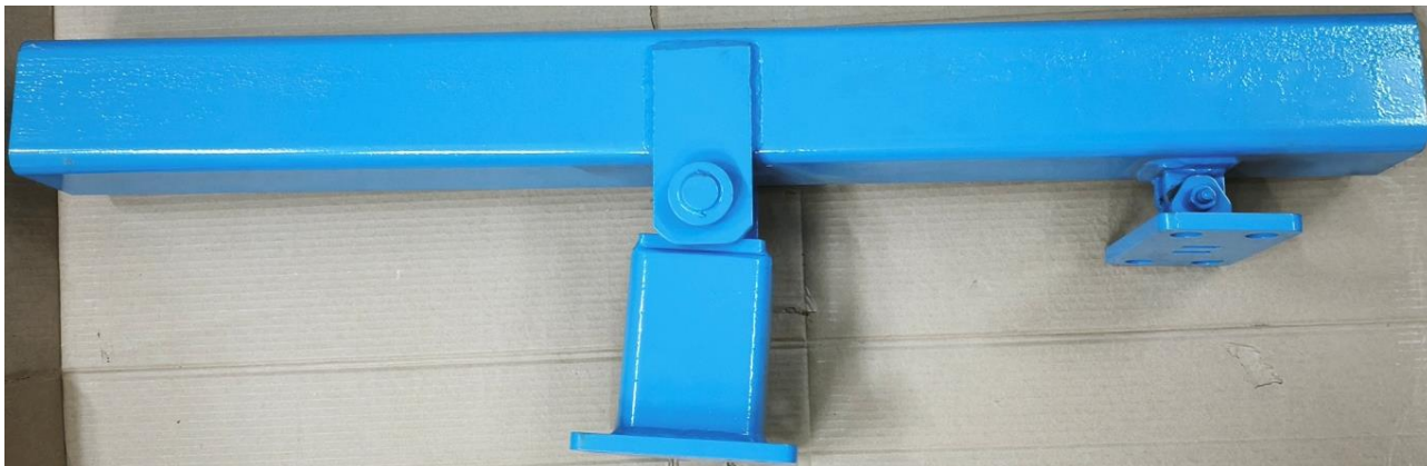
Рисунок 1 – Устройство для измерения тягового сопротивления рабочих органов культиватора
