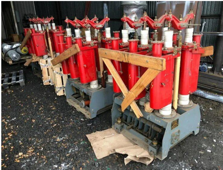
Рисунок 1 - Выключатель маломасляный МГГ-10-5000-45У3
