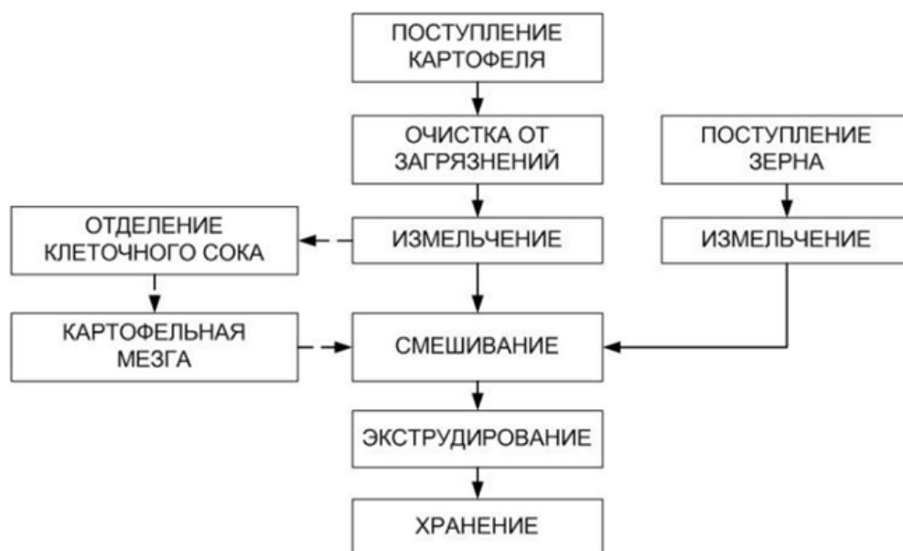
Рисунок 1 – Схема получения экструдата на основе зерна и картофеля [6]
