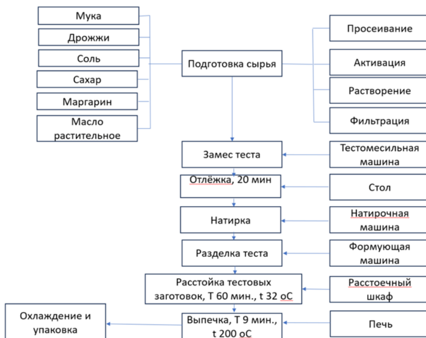
Рисунок 1 – Технологическая схема производства хлебных палочек
