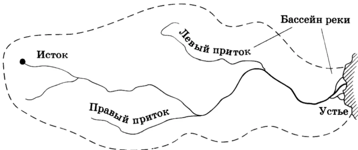
Рисунок 1 — Схема водосборного бассейна
