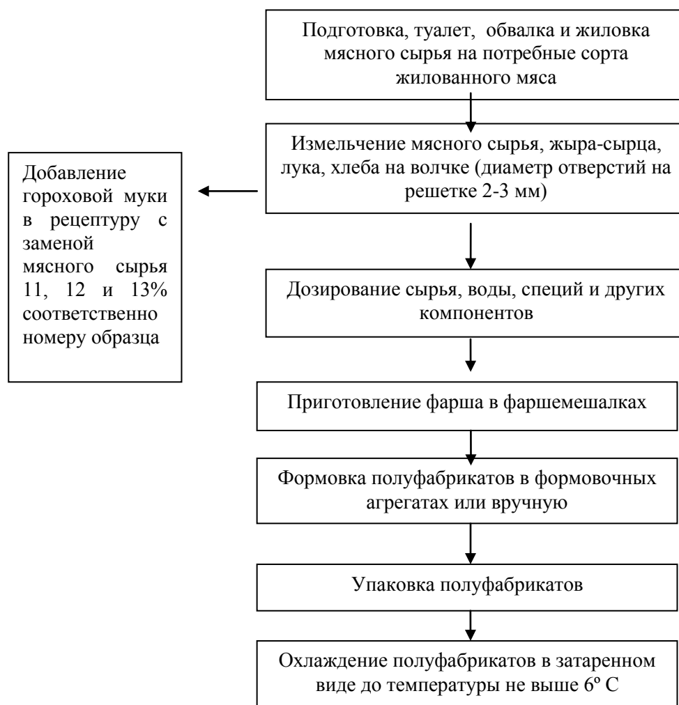
Рисунок 1 – Технологическая схема производства котлет столичных
