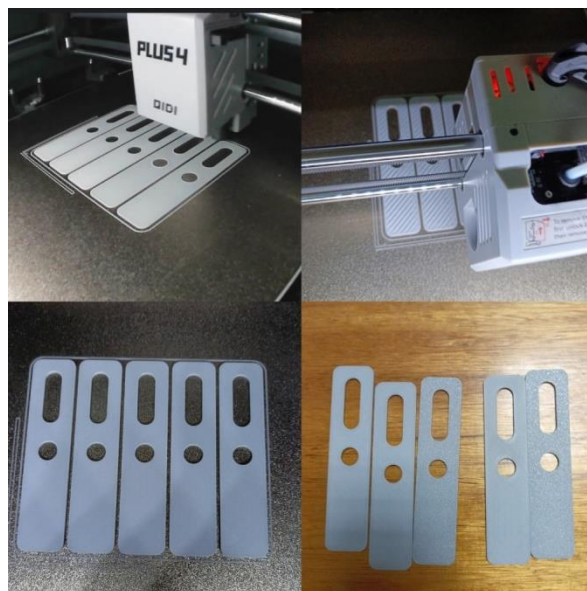
Рисунок 3 – Функциональные прототипы молотков дробильного оборудования, изготовленные на основе 3D-моделей САПР КОМПАС-3D
