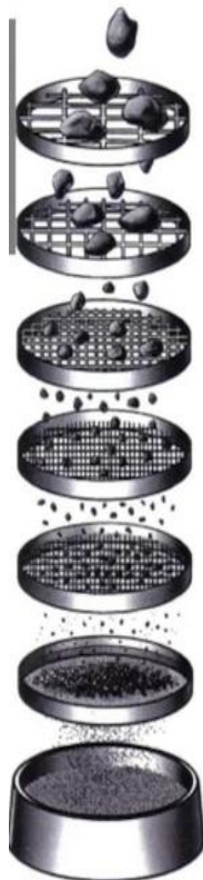
Рисунок 11 – Схема просеивания почвы через ситовой набор
